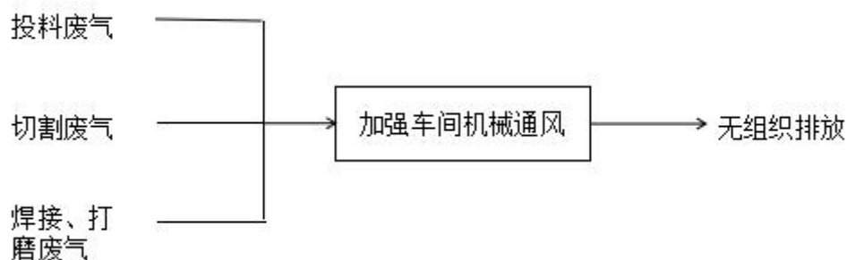
图3-1.1 项目无组织废气收集、处理及排放流程图
